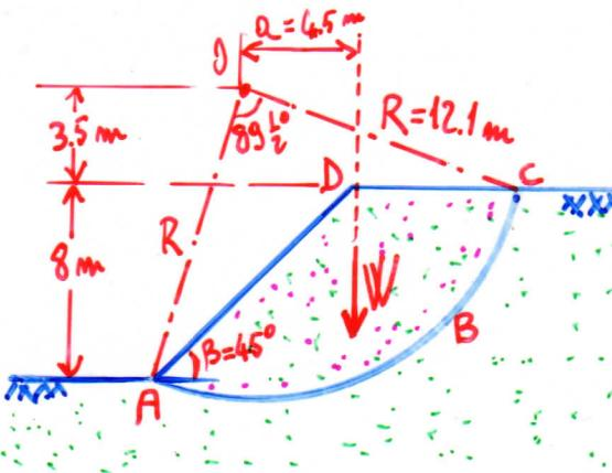
$$\text{Area della sezione trasversale } ABCD = 70 \text{ m}^2$$
