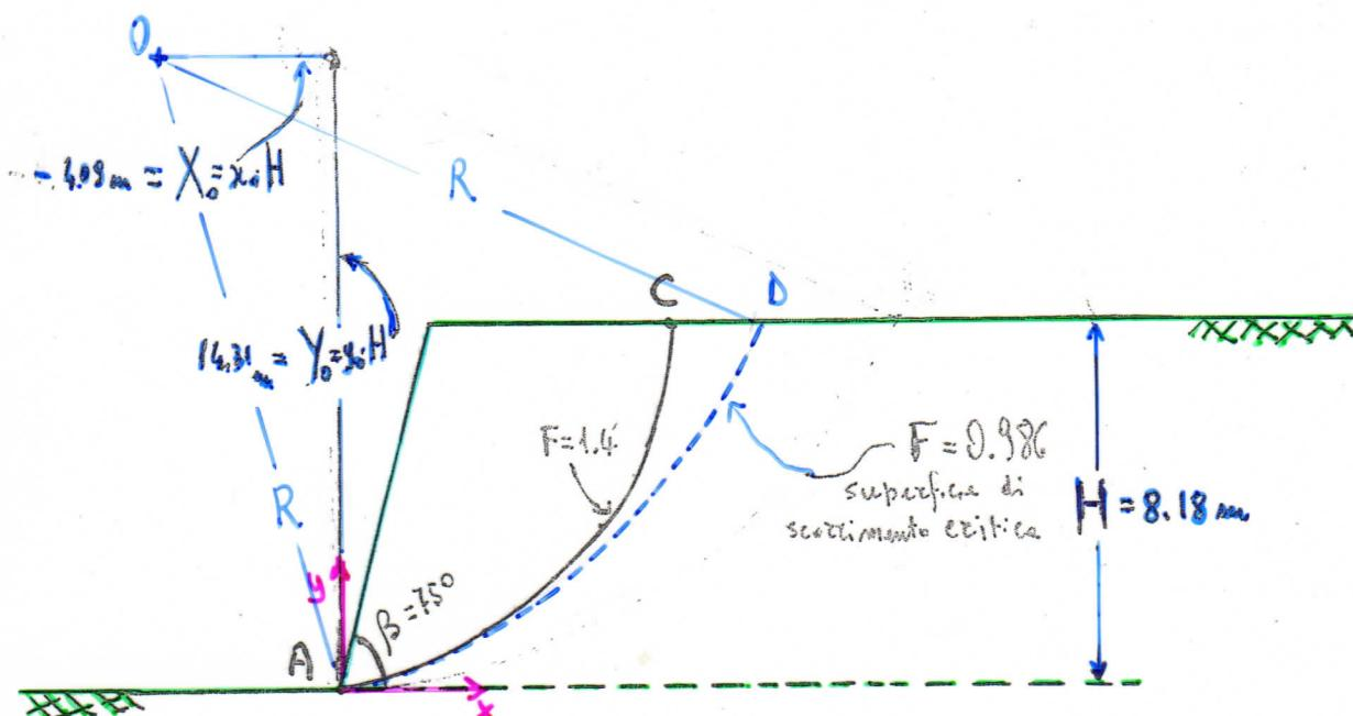
Essendo  $\beta = 75^\circ$ , l'abaco fornisce  $N_o = 4.5$  e ci dice trattarsi di cerchio di piede (toe circle). Ricordando che:  $H = 8.18 \text{ m}$ ,  $c_u = 31 \text{ kPa}$ ,  $\gamma = 17.3 \text{ kN/m}^3$ ,
